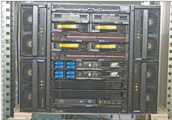
Bild 1: Die Softswitch-Technik ist ausgereift und hat sich bereits bei vielen Carriern bewährt. Im Vergleich mit einem klassischen TDM-Switch sinken die laufenden Energie- und Raumkosten um 50 bis 90 %
