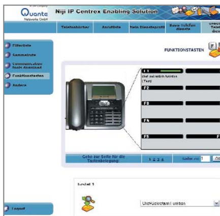
Bild 2: Je nach Berechtigung können alle Mitarbeiter bei der virtuellen TK-Anlage ihre persönlichen Telefonieinstellungen vom Arbeitsplatz aus über ein Webportal anpassen (Self Care) (Bilderquelle: Quante Netzwerke)
